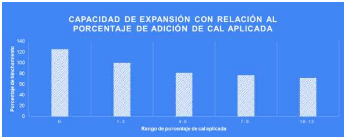
Figura 8. Capacidad de expansión de las arcillas de alta plasticidad.
