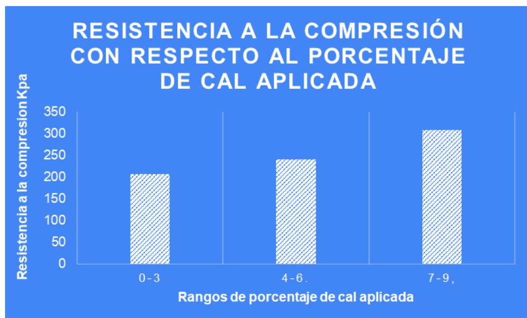
Figura 5. Resistencia a la compresión en Arcillas.
