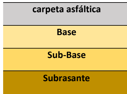
Ilustración 2. Composición del Pavimento Flexible
