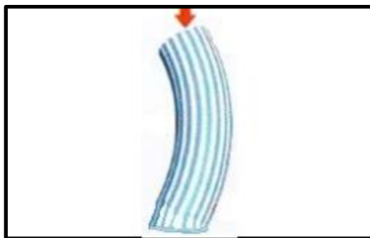
Figura 74. Pandeo en una columna
