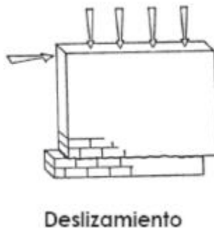
Figura 44. Falla de corte por deslizamiento
